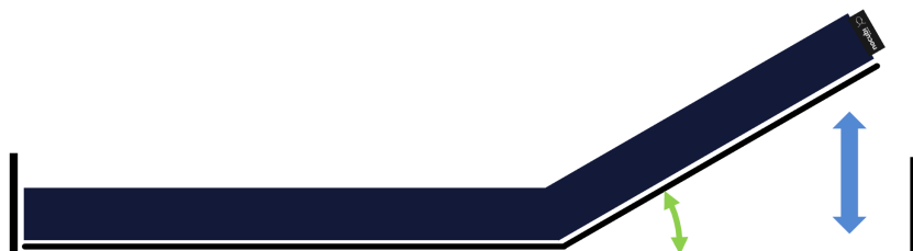
Abbildung 18: Der Druckwechsel ist bis 30° aktiv
